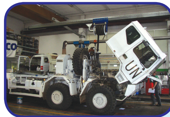
Aspirazione gas di scarico mezzi speciali.
