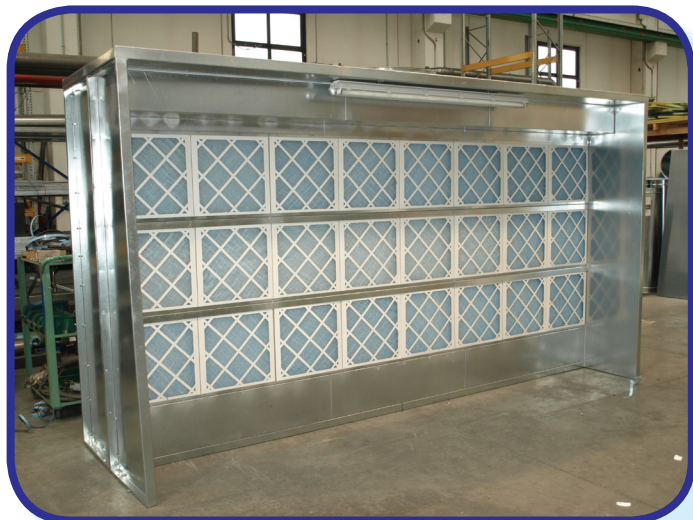
Cabina per verniciatura con aspirazione a secco, con moduli filtranti facilmente sostituibili.
